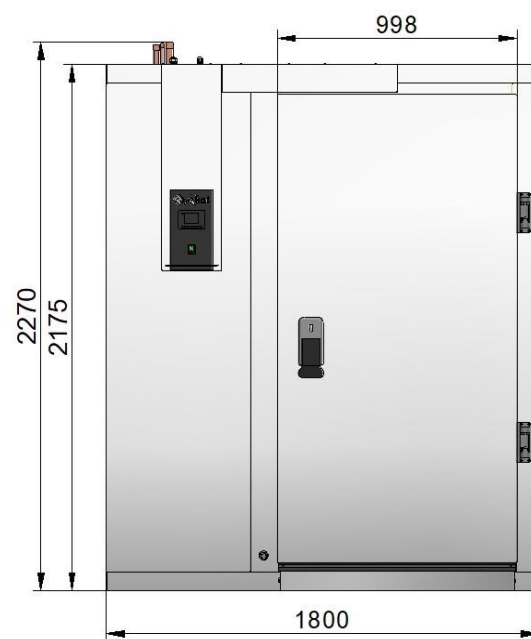
Рис. 4 Габаритные размеры камеры ШОКК-201 и ШОКК-201-01
